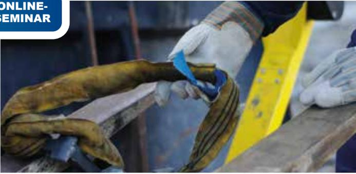
Die bei der Ladungssicherung verwendeten Zurr- und Hilfsmittel unterliegen erheblichem Verschleiß, der bis zur Ablegereife führen kann. Deshalb sind sie vor Benutzung durch den Anwender auf augenfällige Mängel zu prüfen. Die sachkundige Prüfung, die über die augenscheinlichen Mängel hinausgeht, obliegt der hierzu bestellten Befähigten Person.
